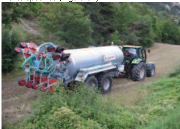
Figura 32 Echipamente pentru împrăștierea nămolului pe terenurile agricole
