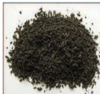
Figura 17 Nămol uscat sub formă de granule (stânga) și paletizat (dreapta)
